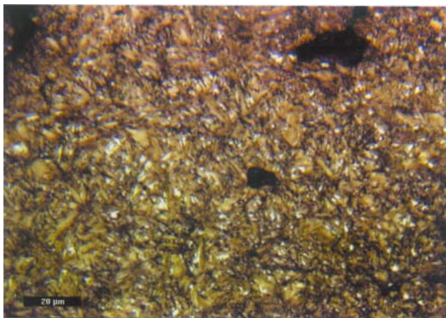
Fig. 1.25 Structura unui OS cu 0,8% C, călit și revenit [52].
