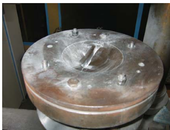
Fig. 2.21 Matriță pentru compactizarea probelor de tracțiune
